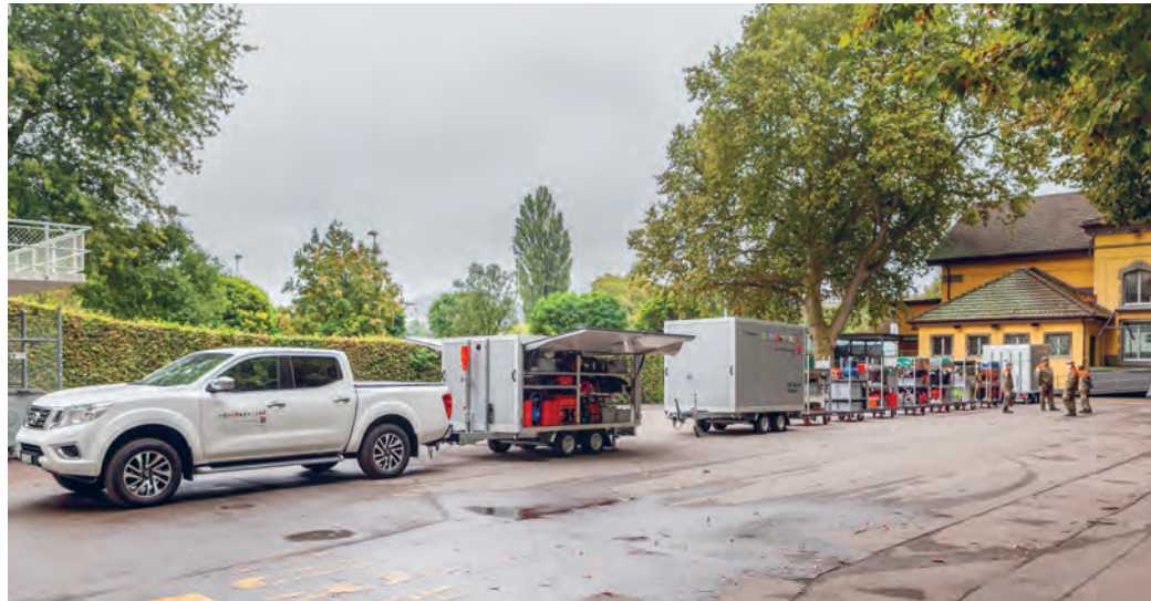
EINSATZANHÄNGER DER RZSO OLTEN MIT VIELFÄLTIGEM INHALT: RETTUNGSMATERIAL, PUMPEN, SCHLÄUCHE, BAUGERÄTE, SEILZÜGE, NOTSTROMAGGREGATE, SCHEINWERFER, ...
