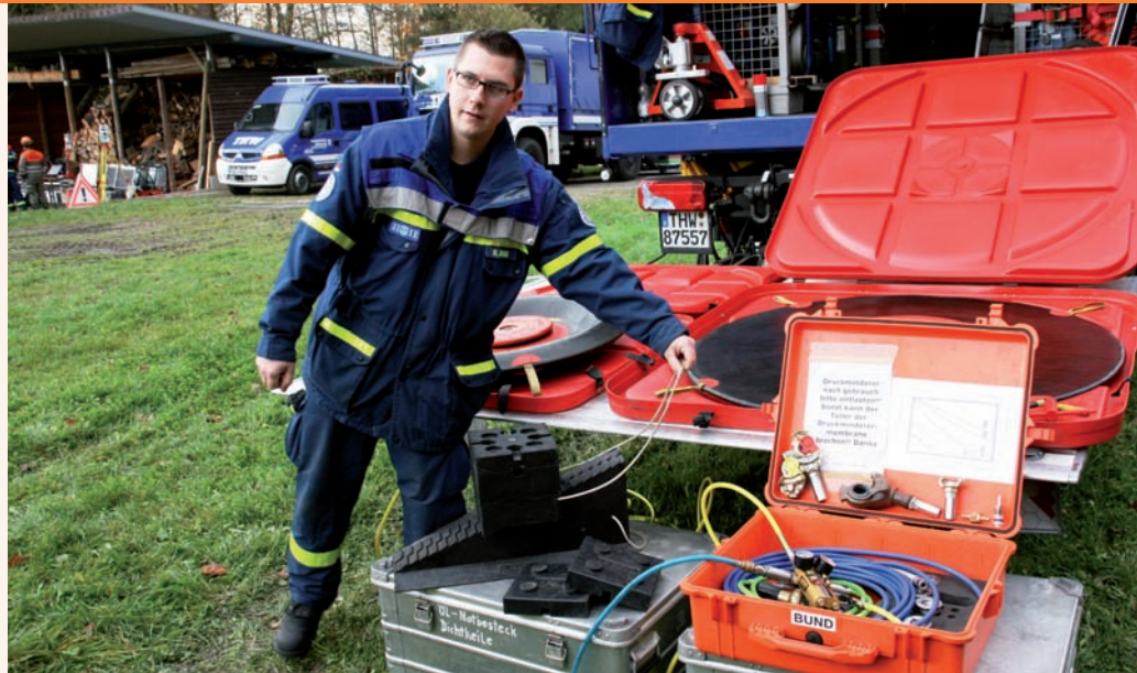
DÉMONSTRATION DE COUSSINS DE LEVAGE.
