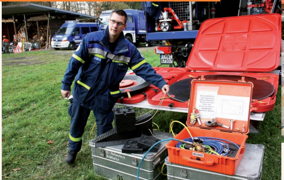
DEMONSTRATION VON GROSSEN HEBEKISSEN.
